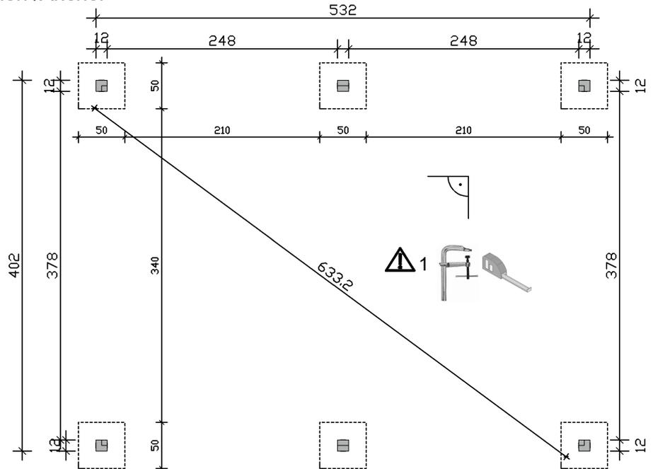
**DE** Positionieren Sie die H-Anker laut Plan und fixieren Sie diese nach Kontrolle. Für die Stabilität ist es wichtig, H-Anker zum Einbetonieren zu verwenden. Diese Anker von Pfosten zu Pfosten je 90° gedreht verbauen, um die größtmögliche Stabilität zu erhalten.
