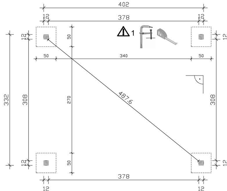
**DE** Positionieren Sie die H-Anker laut Plan und fixieren Sie diese nach Kontrolle. Für die Stabilität ist es wichtig, H-Anker zum Einbetonieren zu verwenden. Diese Anker von Pfosten zu Pfosten je 90° gedreht verbauen, um die größtmögliche Stabilität zu erhalten.
