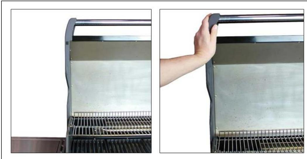
Bei einem ungleichmäßigem Spaltmaß zwischen Brennkammer, Grillkorpus und Untergehäuse sowie Unterwagen: Bitte einmal die Stelle, die nach oben steht, mit Hilfe des Griffes ordentlich nach unten drücken. Hierdurch sollte auch dieses Problem gelöst werden.
