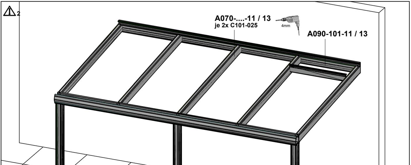
Verteilen Sie die anderen Sparren mit Hilfe der Blendleisten (dienen als Abstandhalter), bohren Sie die Schraublöcher mit einem 4mm Metallbohrer vor und verschrauben Sie die Sparren mit jeweils einer Karoserieschraube (C101-025) an den beiden Pfetten.
