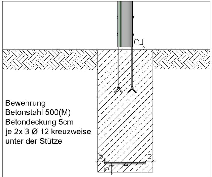
Platzieren Sie den Betonstahl in den Fundamenten, stellen Sie die verschraubte Rinnenkonstruktion in den Fundamentlöchern auf und richten sie darin mit Hilfe von Holzlatten und einer Wasserwaage aus.
